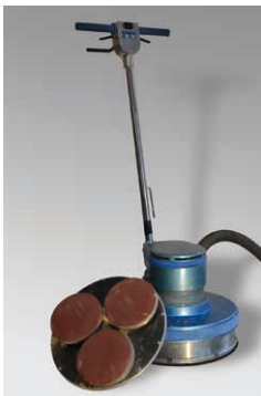
Planschleifmaschine (wie Trio) mit Dreischiebenteller U-400 Planet Gewicht 70kg, dreiteilig (44kg + 23kg + 2kg) zum Anschliessen an Staubsauger dazu: entweder 3 durch Planetengetriebe rotierende kleine Schleifscheiben (18cm) oder Pads/Schleifnetze (40cm)
